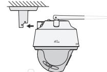
(3) 在下图位置两侧都打入自攻螺钉，将摄像机与支架固定。
