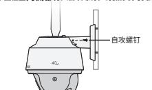
安装完设备后，再给设备连接电源，设备启动完成会自动接入4G网络，待设备绿灯常亮，即可正常使用。
