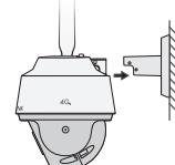
(3) 在下图位置两侧都打入自攻螺钉，将摄像机与支架固定。
